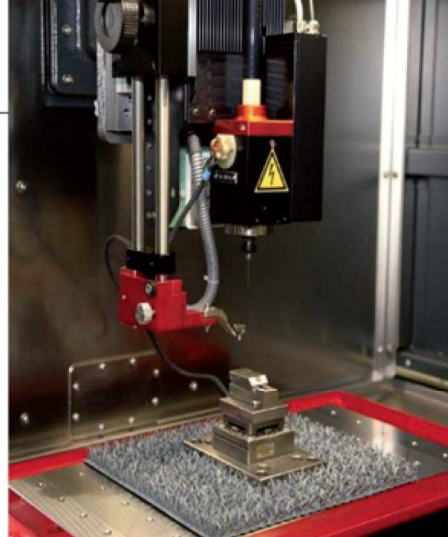
Il nuovo porta guida ad alta precisione con regolazione manuale
