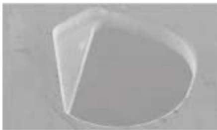
Микроэрозионное фрезерование микроформ 200 микрон со ступенчатой полостью глубиной 50 мкм
