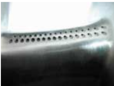
Микроэрозионное сверление сопел в лопатке турбины авиадвигателя
