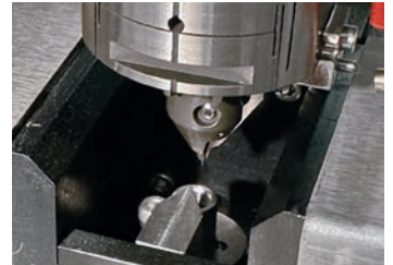
SX-Laser measuring • Laser pour la mesure du diamètre/profil des électrodes pour SX-Arianne – Résolution de 0,10 \mu\text{m} – Mesure minimale de 0,005 \text{ mm}
