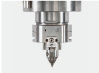
SP06 • Pince à haute précision avec avance automatique d'électrode – Réglage de la concentricité – Lavage interne à haute pression – Gamme de \varnothing 0,05 à \varnothing 1,5 \text{ mm} – Jusqu'à \varnothing 0,99 , s'adapte à une gamme de serrage de 0,04 \text{ mm}
