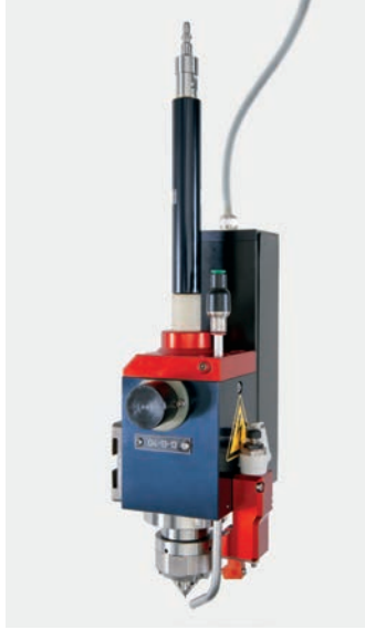
SX-A344L • Broche rotative à avance automatique et compensation d'usure d'électrode – Lavage interne à haute pression – Mandrin 3R – Excentricité \pm 1 \mu\text{m} – Vitesse max 850 rpm – Pour pinces SP06, SP12 et SP-MDC
