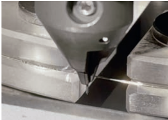
SX-Arianne • Unité d'érosion à fil – Conçu pour produire des micro électrodes pour micro trous et micro formes jusqu'à \varnothing 10 \mu\text{m} – Fil \varnothing 0.10 et 0.20 \text{ mm}
