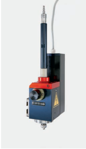
SX-ROT • Broche rotative à avance manuelle d'électrode – Lavage interne à haute pression – Mandrin 3R – Excentricité \pm 1 \mu\text{m} – Vitesse max 850 rpm – Pour pinces SP02, SP03 et SP04
