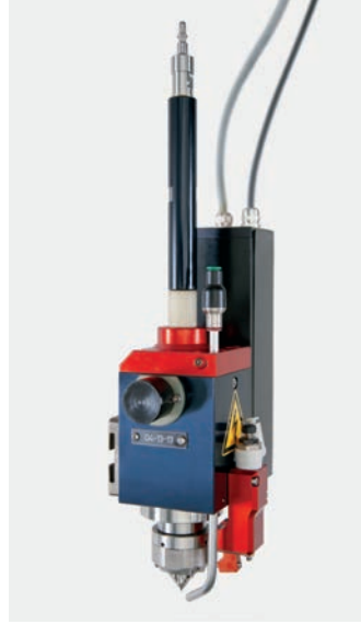
SX-C-A344L • Broche rotative indexable à avance automatique et compensation d'usure d'électrode – Lavage interne à haute pression – Mandrin 3R – Résolution 0.00625^\circ – Vitesse max 600 rpm – Pour pinces SP06, SP12 et SP-MDC
