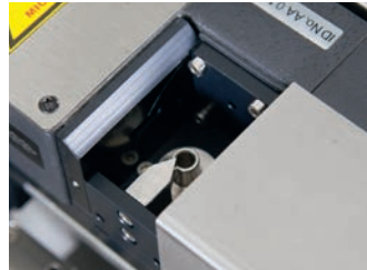
SX-Laser measuring • Laser pour la mesure du diamètre/profil des électrodes pour SX-Arianne – Résolution de 0,10 \mu\text{m} – Mesure minimale de 0,005 \text{ mm}
