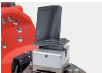
SX-Axe rotatif A/B • Axe A/B de haute précision – Axe rotatif A \pm 115^\circ – Axe rotatif B 360^\circ – Mesure directe de l'axe – Pour mandrin 3R ou EROWA – Résolution 0,0001 \text{ degré} – Lavage interne du porte-pièce
