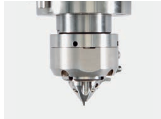
SP12 • Pince à changement rapide à haute précision avec avance automatique d'électrode – Réglage de la concentricité et de l'inclinaison – Lavage interne à haute pression – Gamme de \varnothing 0,05 à \varnothing 1,5 \text{ mm} – Jusqu'à \varnothing 0,99 il s'adapte à la gamme de serrage de 0,04 \text{ mm}
