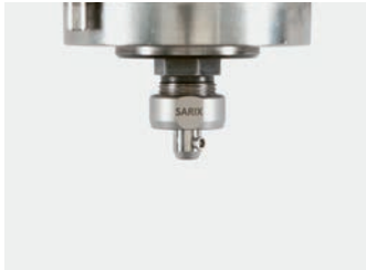
SP02 • Pince à haute précision avec avance manuelle d'électrode – Lavage interne à haute pression – Gamme de diamètres de \varnothing 0,05 à \varnothing 3,0 \text{ mm}
