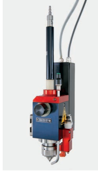
SX-C-A344L • Indexierbare Automatischer Elektrodenvorschub und Verschleiß Kompensation – Internes Hochdruckspülung – 3R-Spannfutter – 600 U/min – Für Spannzangen SP06, SP12 und SP-MDC
