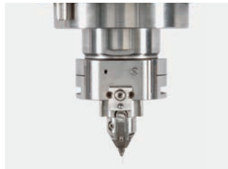
SP06 • Hochpräzise Spannzange mit automatischem Elektrodenvorschub – Rundlaufeinstellung – Internes Hochdruckspülung – \varnothing 0,05 bis \varnothing 1,5 mm – Bis \varnothing 0,99 mit Spannbereich von 0,04 mm
