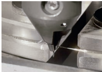
SX-Arianne • Drahterodiereinheit – Zur Mikroelektroden Herstellung für Mikrobohrungen und Mikroformen bis zu \varnothing 10 \mu\text{m} – Draht \varnothing 0,10 und 0,20 mm
