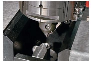
SX-Laser-Messung • Laser zur Elektrodendurchmesser-/Profilmessung für SX-Arianne – Auflösung von 0,10 \mu\text{m} – Mindestabmessung von 0,005 mm
