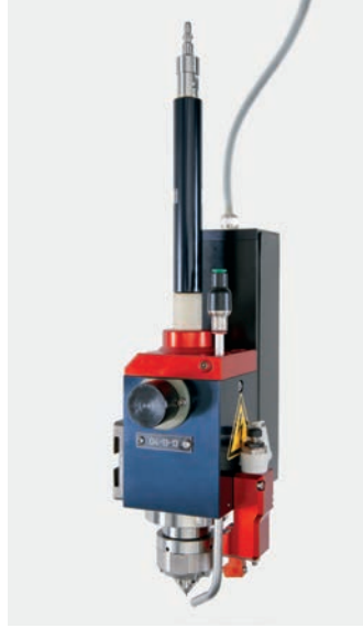
SX-A344L • Automatischer Elektrodenvorschub und Verschleiß Kompensation Spindel – Internes Hochdruckspülung – 3R-Spannfutter – Rundheit \pm 1 \mu\text{m} – 850 U/min – Für Spannzangen SP06, SP12 und SP-MDC
