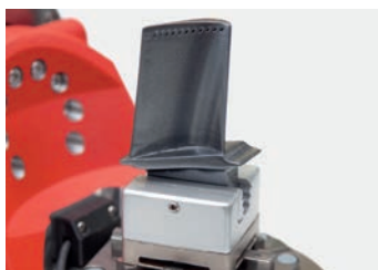
SX-A/B Dreh-Schwenkachsen • Hochpräzise A/B-Achse – A Drehachse \pm 115^\circ – B Drehachse 360^\circ – Direkte Achsmessung – Entworfen für 3R- oder EROWA-Spannfutter – Auflösung 0.0001 Grad – Werkstück halter interne spülung
