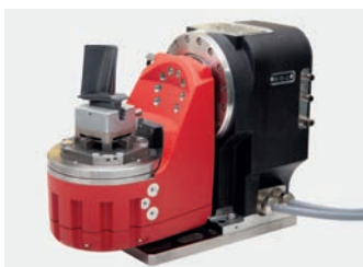
SX-A/B Dreh-Schwenkachsen • Hochpräzise A/B-Achse – A Drehachse \pm 115^\circ – B Drehachse 360^\circ – Direkte Achsmessung – Entworfen für 3R- oder EROWA-Spannfutter – Auflösung 0.0001 Grad – Werkstück halter interne spülung
