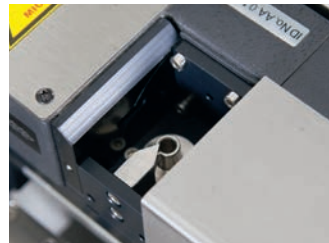
SX-Laser-Messung • Laser zur Elektrodendurchmesser-/Profilmessung für SX-Arianne – Auflösung von 0,10 \mu\text{m} – Mindestabmessung von 0,005 mm
